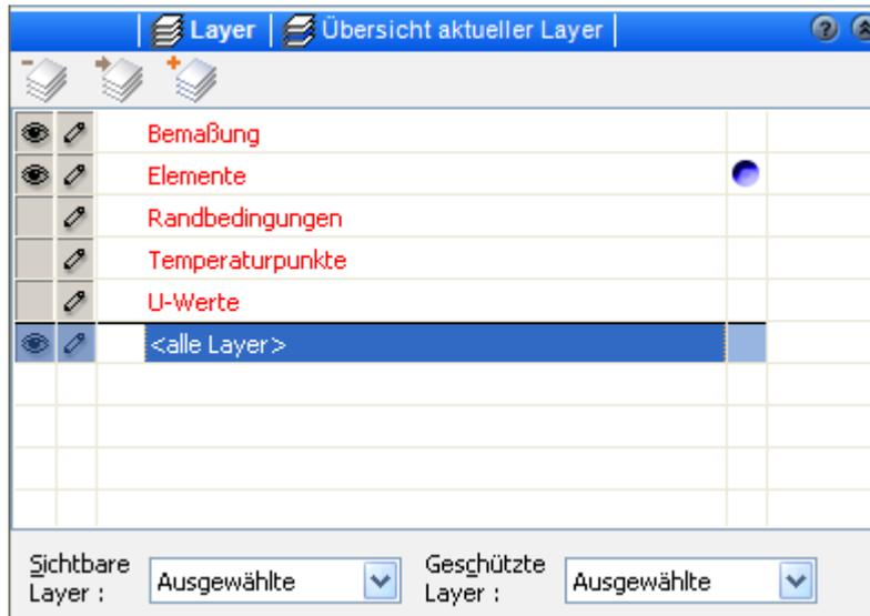
Layer, die durch das Zeichen von Elementen mit fixer Layerzuordnung entstanden sind, werden rot dargestellt. Freie, durch den Benutzer angelegte Layer, sind schwarz.
