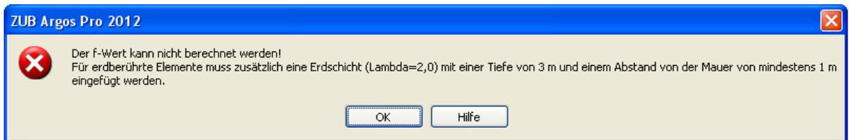
Bei der f-Wert-Berechnung muss zusätzlich eine Erdschicht ( $\lambda = 2,0$ ) mit einer Tiefe von 3 m und einem Abstand von der Mauer von mindestens 1 m eingefügt werden ([siehe Randbedingungen](#)).
