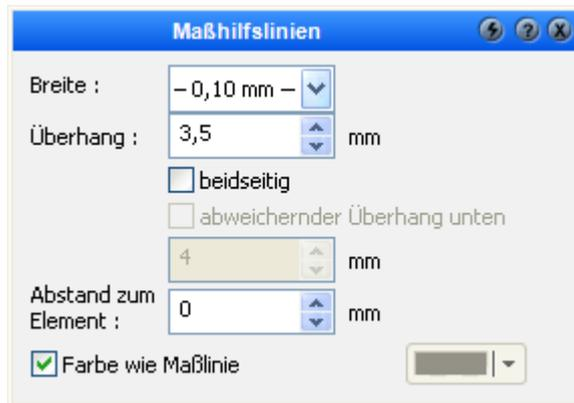
Maßhilfslinien sind die senkrecht zur Maßlinie liegenden Linien am Anfangs- und Endpunkt. Maßhilfslinien können mit dem Überhang, (oben und unten gleich) beidseitig oder bis zu den Maßpunkten (mit dem Abstand bis zum Element) geführt werden.
