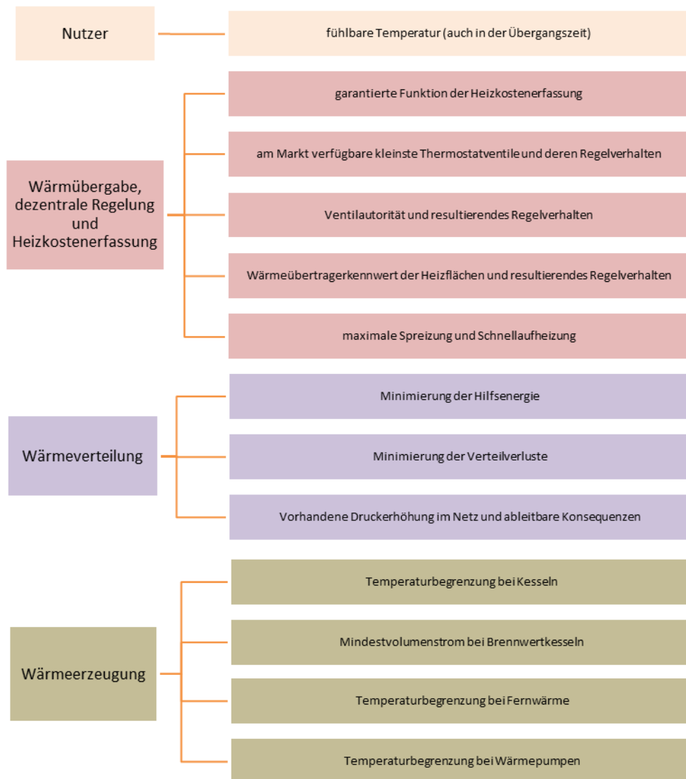
Abbildung 2: Einflussfaktoren für die Wahl einer bestimmten Vorlauftemperatur
